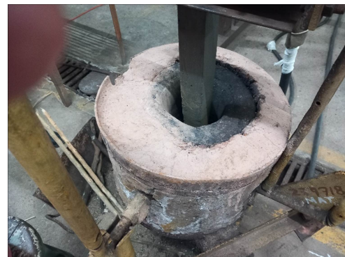
Figura 1. Horno de arco eléctrico de C.D, empleado en las pruebas de Fusión reductora. Fuente: (CIS, 2024)
