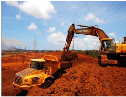
Figura 5. Sistema de extracción y transporte del mineral laterítico.
