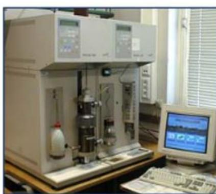
Figura 6. Sortómetro automático, modelo 1800, Carlo Erba
