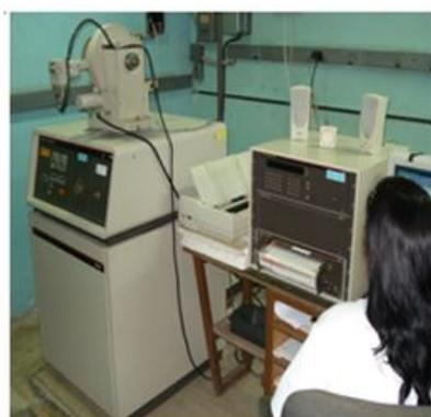
Figura 5. Difractómetro de polvos de rayos-X (CIPIMM)
