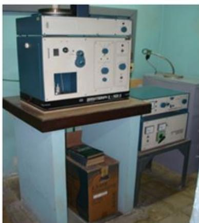
Figura 3. Derivatógrafo MOM- 1500Q (CIPIMM)
