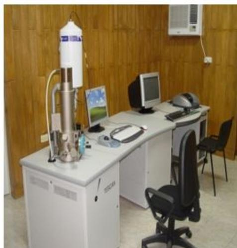
Figura 8. Microscopio Electrónico de Barrido MEB-EDS (LCC-MININT)
