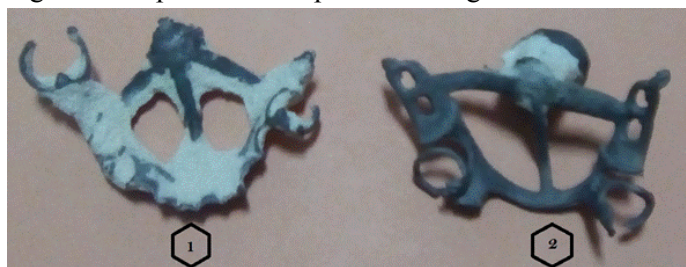
Figura 15. Estructura metálica de una prótesis dental antes (1) y después (2) de ser pulida con el concentrado de granate
